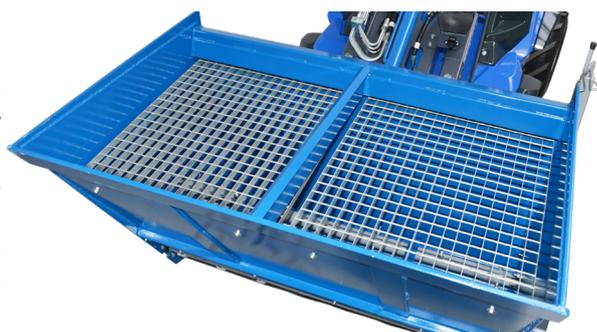
Солеазбрасыватель предназначен для быстрого и эффективного распределения соли. Установка на стрелу позволяет загружать соль с земли так же, как и обычным ковшем. Солеазбрасыватель приводится в действие гидравлическим двигателем и оснащен осью смесителя, которая разбивает любую замороженную соль и предотвращает ее застревание. Он идеально подходит для разбрасывания соли или песка на парковках, тротуарах, велосипедных дорожках и в пешеходных зонах.
